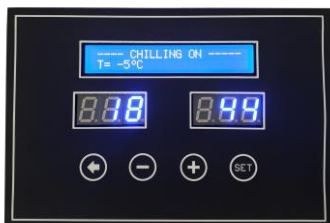
Versione FE1036: l'interfaccia è fornita in scatola stagna. Sotto, un esempio di prodotto finito - mascherina non fornita. FE1036 version: the interface is provided in a sealed box. Below, an example of the finished product - overlay not included.
