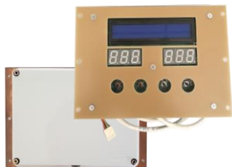
Versione FE1036: l'interfaccia è fornita in scatola stagna. Sotto, un esempio di prodotto finito - mascherina non fornita. FE1036 version: the interface is provided in a sealed box. Below, an example of the finished product - overlay not included.
