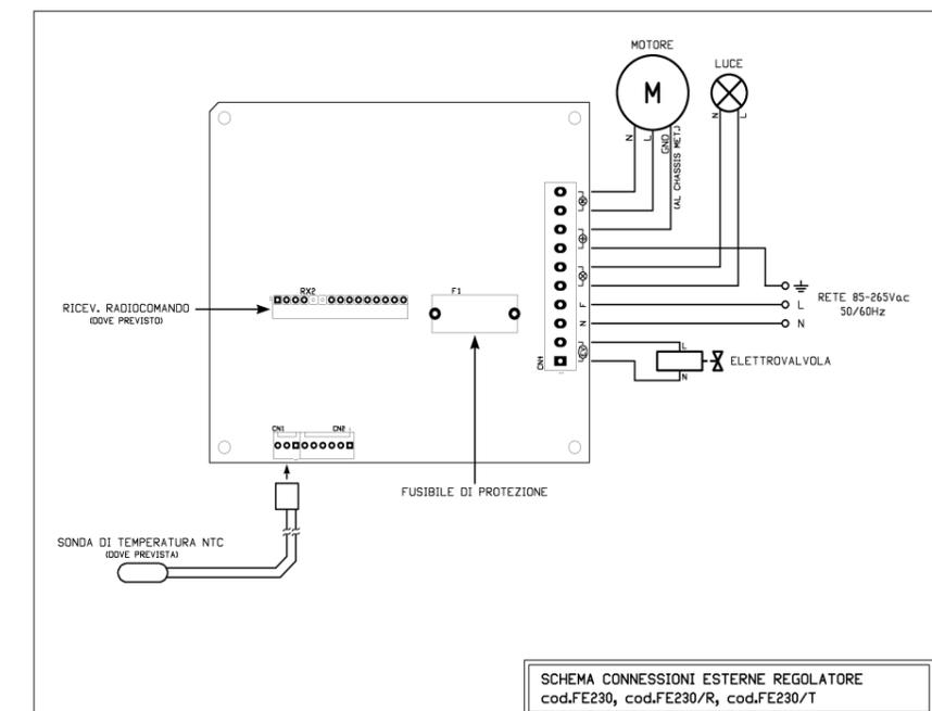
Fig. 2: Schema di connessioni esterne del regolatore.
